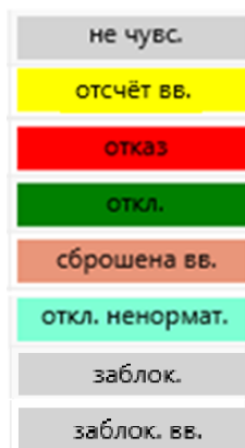
Состояния ступеней защит
