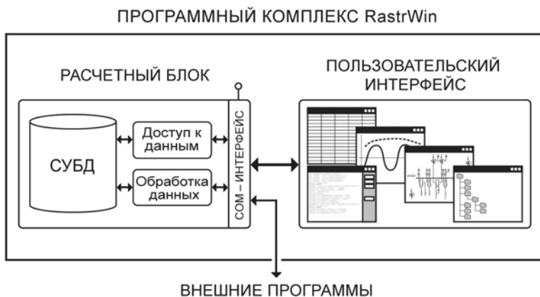
Рис. 4. Архитектура программного комплекса RastrWin-Lincor
