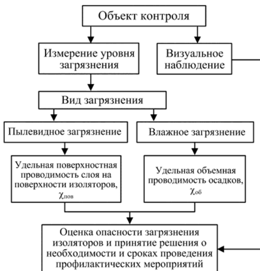
Рис. 6. Структура контроля состояния изоляции в процессе эксплуатации
