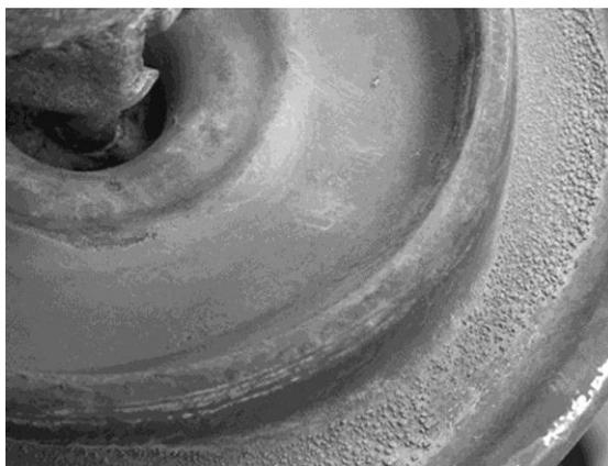
б – участок нижней поверхности фарфорового тарельчатого изолятора типа ПФ-6Б
