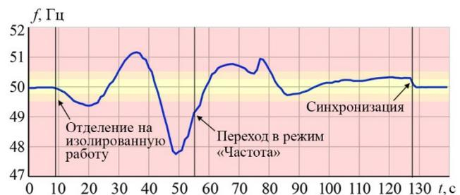
**Рис. 6.** Характер изменения частоты в опыте со сбалансированным отделением двух ГА Серебрянских ГЭС на работу в изолированном районе при исходной работе САУ ГА в режиме «Мощность». Повторно скорректированные алгоритмы и параметры настройки
