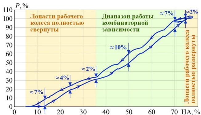
**Рис. 5.** Зависимость мощности одного из ГА ( $P$ ) Серебрянских ГЭС от положения штока сервомотора направляющего аппарата (НА) при его медленном однонаправленном изменении
