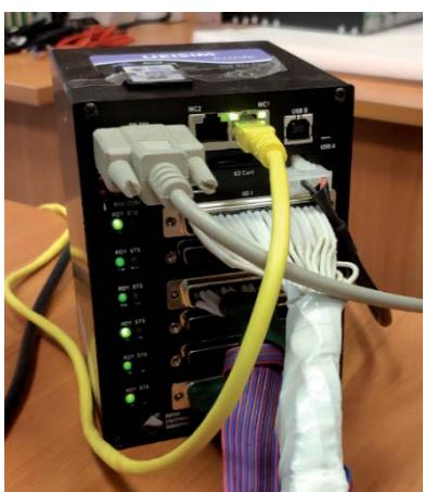
**Рис. 3.** Макет устройства АЛАР. Устройство UEISIM обрабатывает аналоговые сигналы от RTDS, передавая их на вход алгоритмов и формируя осциллографы с результатами их работы. Персональный компьютер используется для управления тестовой схемой на RTDS, создания и компилирования алгоритмов, хранения осциллографов.
