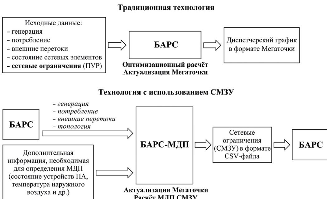
**Рис. 1.** Сравнение традиционной технологии планирования и технологии планирования с использованием ПК БАРС-МДП
