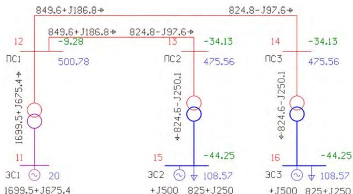
Рис. 9. Утяжелённый режим в случае двух ЛЭП в КС
