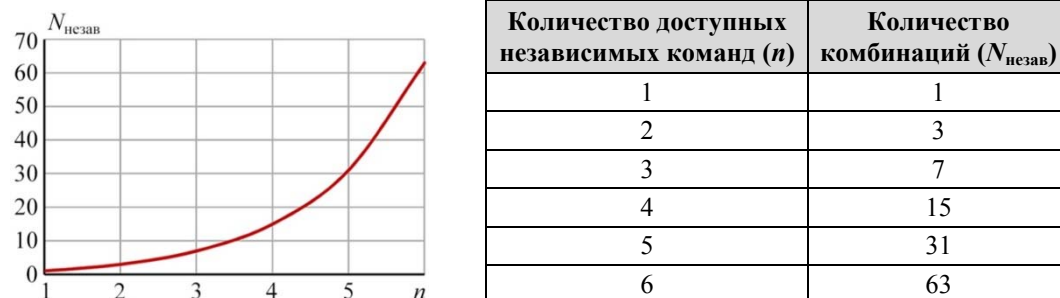
Рис. 3. График зависимости количества комбинаций команд N_{\text{незав}} , которые возможно получить из n доступных независимых команд САОН ( n = 1, 2, 3, 4, 5, 6 )
