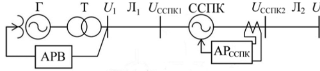
Рис. 2. Схема электропередачи с ССПК: АРССПК – автоматический регулятор
