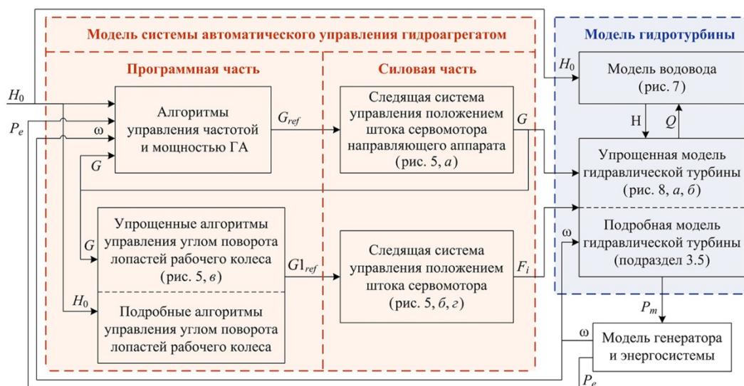
Рис. 4. Структурная схема, описывающая связи между различными элементами математической модели гидротурбины:
