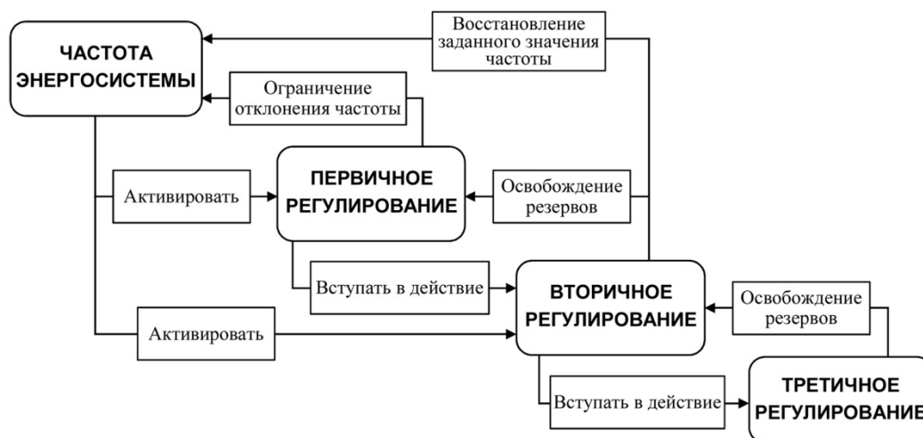
Рис. 1. Структура регулирования частоты в ЕЭС России
