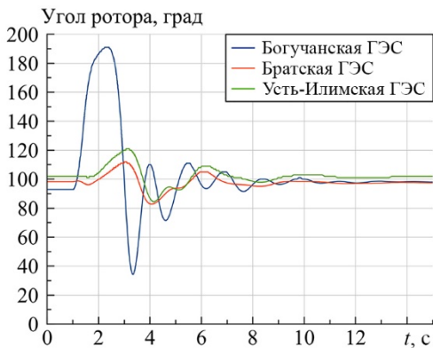
Рис. 11. Угол ротора электростанций ОЭС Сибири при нормативном возмущении P_{ГЭС} = 2224 МВт (ФПТ отсутствует)
