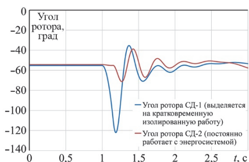
Рис. 11. Углы роторов синхронных двигателей, подключенных к секциям 6 кВ РУ 6 кВ ПС 110 кВ «ГПП А»
