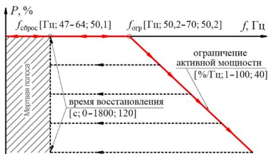
Рис. 2. Инкрементная характеристика ограничения активной мощности по функции  $P(f)$
