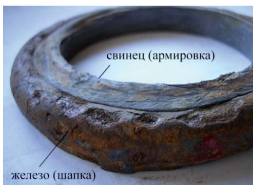
Рис. 3. Коррозия шапки длинностержневого изолятора после пропускания количества электричества 20 А·ч
