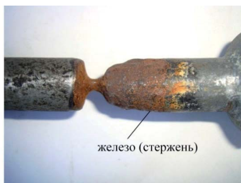
Рис. 4. Коррозия стержня тарельчатого изолятора после пропускания количества электричества 20 А·ч
