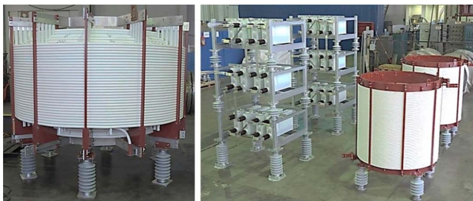
Рис. 3. Полуобмотка сглаживающего реактора, КБ и реакторы ФДУ (слева направо)
