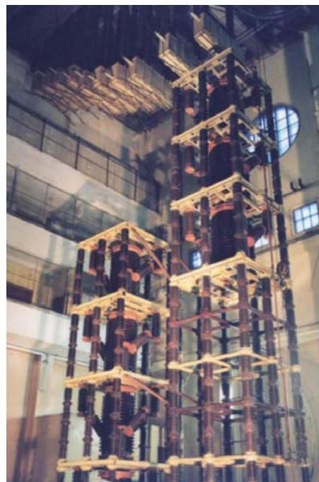
Рис. 5. Испытательная установка постоянного тока 1200 кВ, 0,3 А
