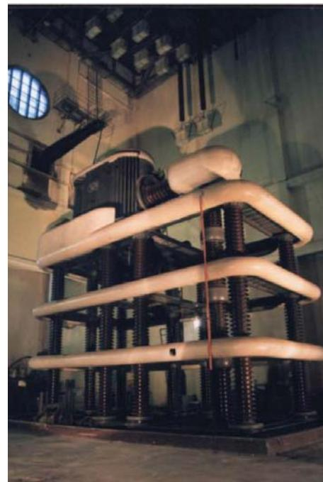
Рис. 4. Испытательный трансформатор 750 кВ, 2 А
