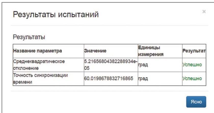
Рис. 11. Пример результатов испытания проверки синхронизации УСВИ
