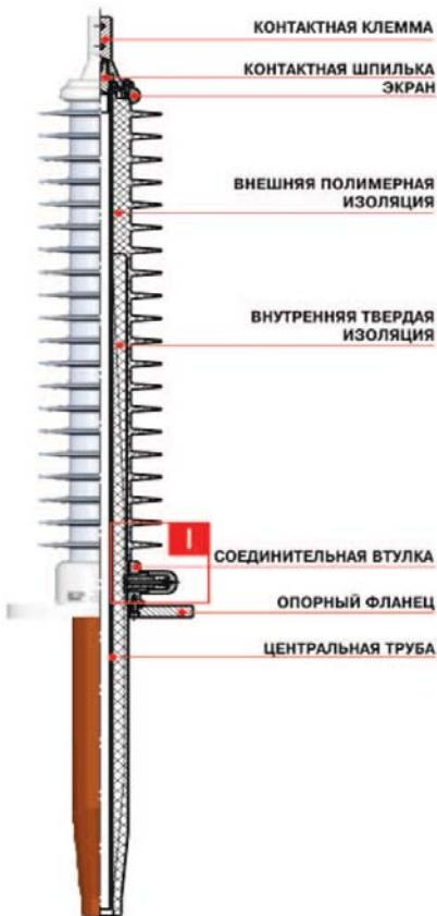
Рис. 1. Ввод с внешней полимерной изоляцией
