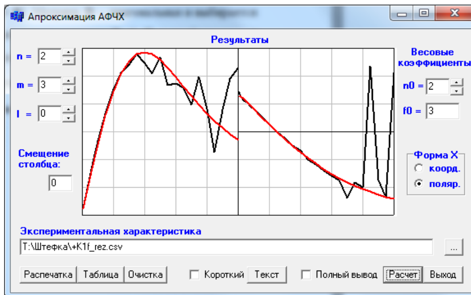
Рис. 1. Окно программы при аппроксимации данных с наличием «шума», полученных на основе физической модели энергосистемы
