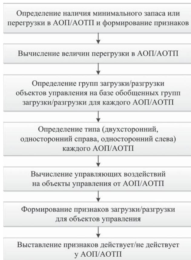
**Рис. 2.** Структурная схема алгоритма работы АОП/АОТП
