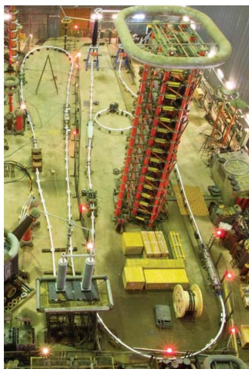
**Рис. 5.** Предквалификационные испытания кабельных систем 220 и 330 кВ со СПЭ-кабелями
