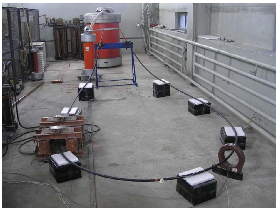
**Рис. 2.** Типовые испытания СПЭ-кабеля 6 кВ
