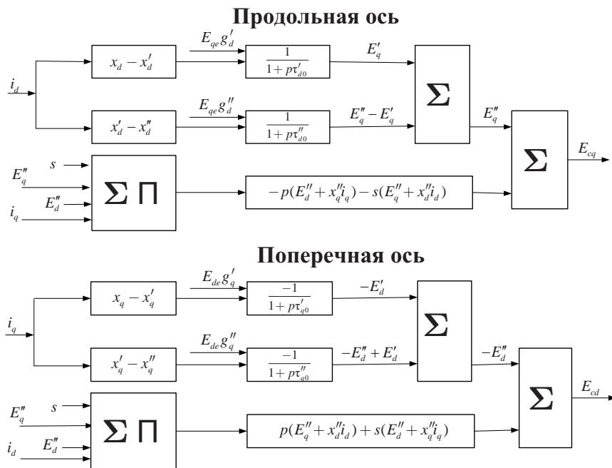
**Рис.1.** Схема расчета электромагнитных и электромеханических переходных процессов синхронной машины с продольно-поперечным возбуждением
