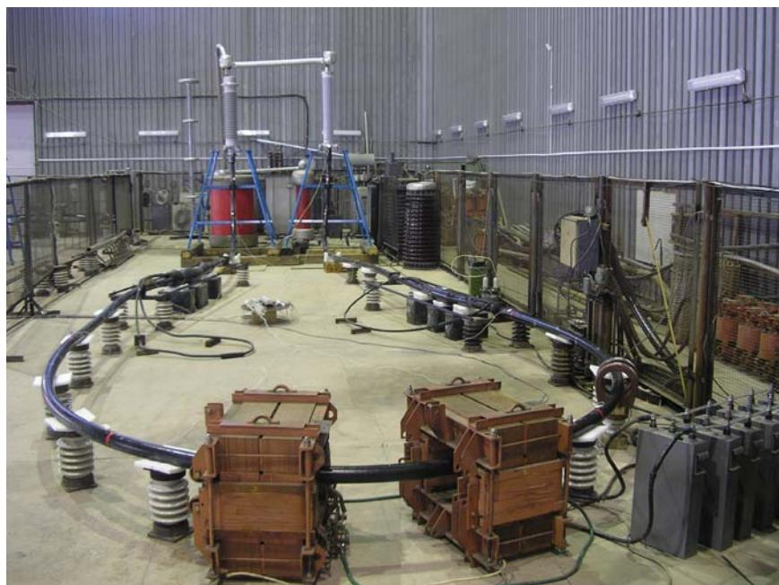
**Рис. 4.** Типовые испытания кабельной системы 110 кВ со СПЭ-кабелем
