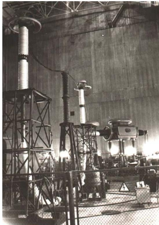
**Рис. 1.** Испытания кабельной системы 220 кВ высокого давления на стенде 600 кВ
