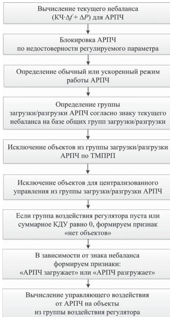
Рис. 1. Структурная схема алгоритма работы АРПЧ
