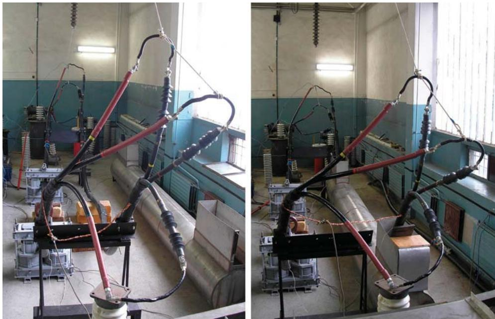
**Рис. 3. Совмещенные испытания СПЭ-кабеля и кабельных муфт 35 кВ**
