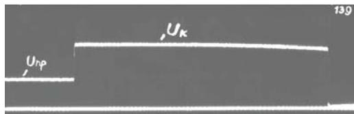
**Рис. 8.** Осциллограмма импульса напряжения прямоугольной формы:
