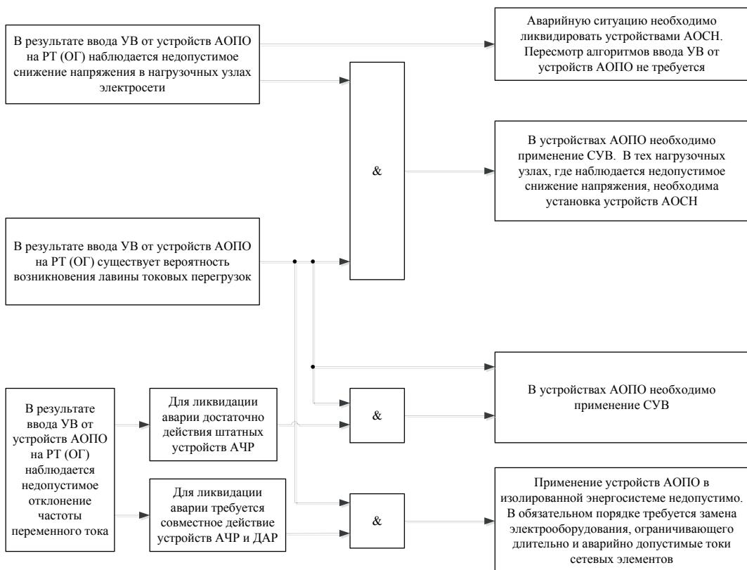
**Рис. 16.** Структурная блок-схема, описывающая методику УВ устройств АОПО
