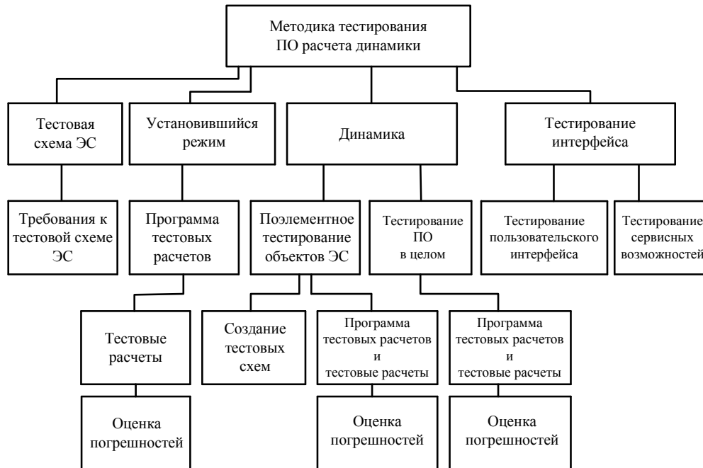
Рис. 1. Структурная схема предлагаемой методики тестирования нового и имеющегося ПО для анализа динамической устойчивости
