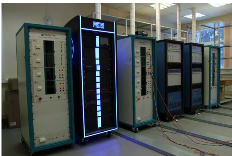
Программно-аппаратный комплекс «Цифровая модель реального времени» (RTDS)
